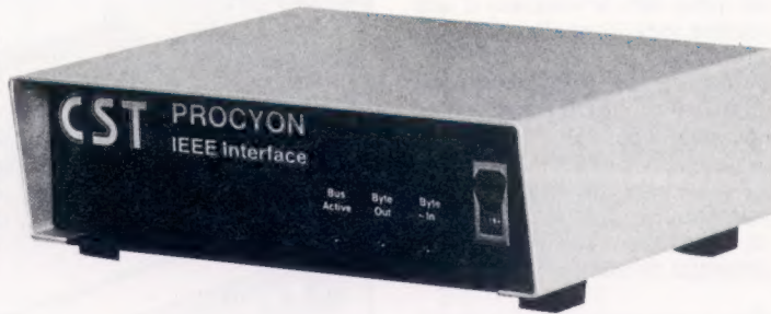
Une interface IEEE-488, à utiliser avec le micro-ordinateur BBC.
